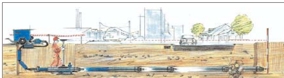
Fig. 12: Siluro - attraversamento stradale
