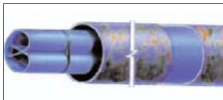
Fig.16: Deformazione a 'C' nel caso Folded-lining
