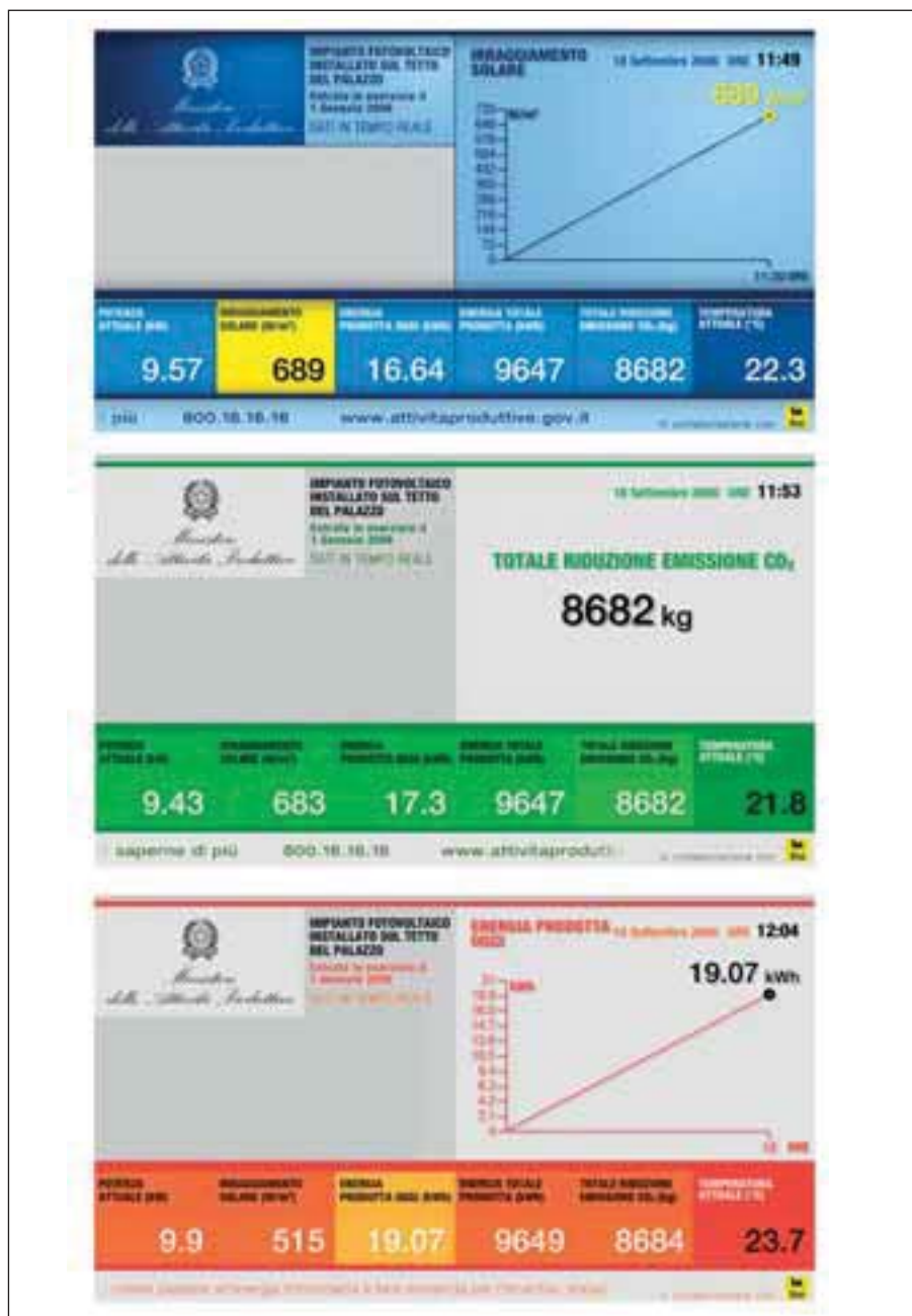
Grafici del monitoraggio dell'impianto fotovoltaico del Ministero dello Sviluppo Economico.
